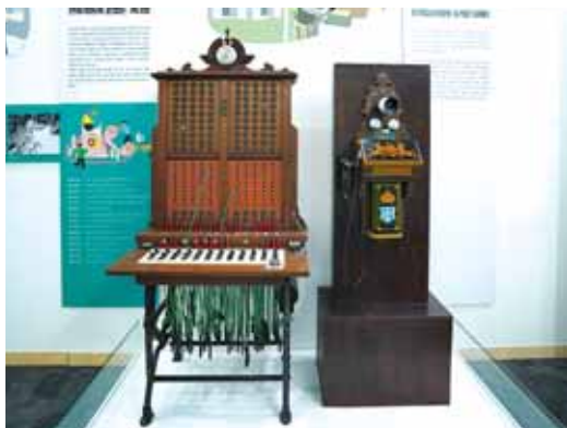
에릭슨 자석식 전화기(복제), 1980년 최초의 전화교환기술은 자석식으로서 전화기 옆에 달린 발전기를 돌리면 교환원이 직접 상대방과 통화접속을 시켜주었다.
